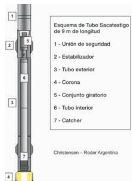
FIGURA 1.9. Diagrama esquemático de la herramienta utilizada para extraer testigos corona.
